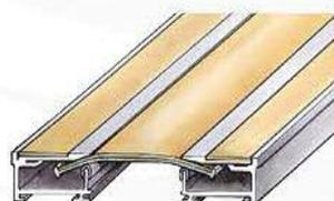
»»» Joints de dilatation sismiques spécial sols souples
