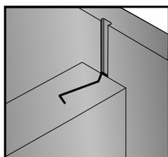
Pour la reprise de mur maçonné sur mur banché
